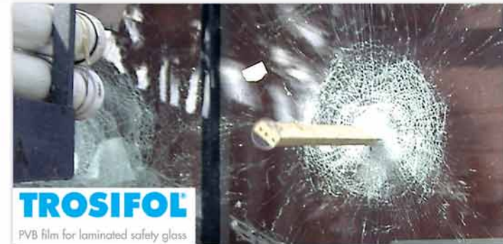
Bruchprüfung der Hurrikan-Verglasung
